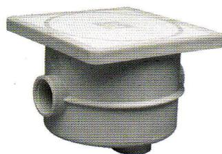
La caja de registro de ABS cuenta con dos puntos de conexión laterales y uno inferior que son compatibles con el conducto flexible del reflector Hayward Euro Light para una instalación sencilla. La tapa de presión tiene un sello o-ring para impedir la entrada de polvo y agua. Los sellos del cable y conexión eléctrica están incluidos.
